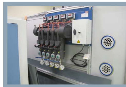
• 电力电子控制器耐久测试台架
